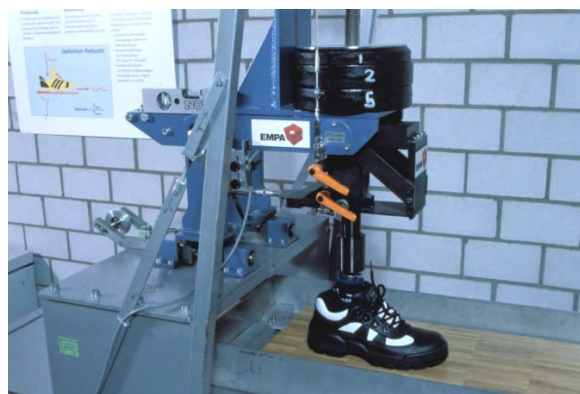
Illustration 6 Dispositif d'essai pour sols et chaussures BST 2000
