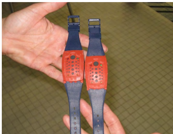
Illustration 28 Bracelets d'un système de détection des noyades
