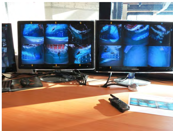
Illustration 27 Ecrans d'un système de détection des noyades
