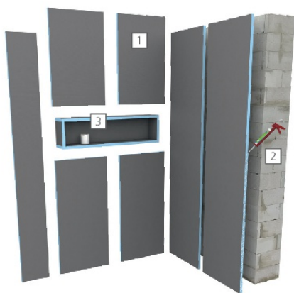
A Réalisation du système : paroi de douche
