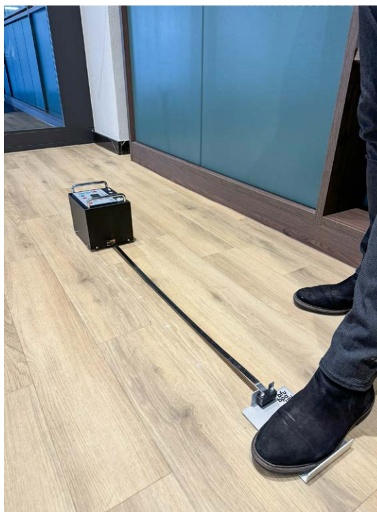
Illustration 2: Détermination de la résistance à la glissance des revêtements de sol à l'aide de la méthode d'essai sur un plan incliné (à gauche) et avec un tribomètre (à droite)
